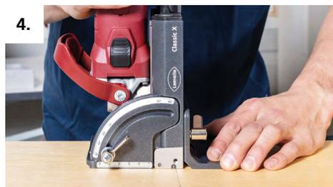
4. Aligner la machine sur le marquage central et effectuer le fraisage dans la surface.
