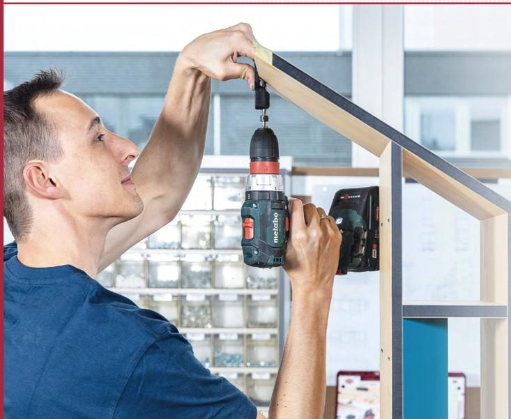
Les matériaux de faible épaisseur sont de plus en plus importants dans la conception de meubles. Lamello propose désormais encore plus de flexibilité aux menuisiers lors de la production et du montage. Le Clamex S-20 permet d'assembler de manière démontable des matériaux d'une épaisseur minimale de 8 mm. Grâce à la rainure de 4 mm, il est possible de monter le Clamex S-20 avec n'importe quelle fraiseuse à rainurer du commerce.
