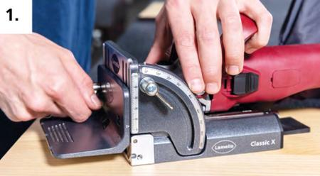
1. Mettre en place la butée angulaire et la régler à la moitié de l'épaisseur du matériau.
