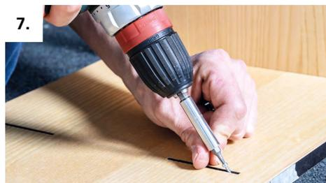
7. Fixer ensuite les moitiés de l'élément d'assemblage à l'aide des vis fournies. Pour les matériaux fragiles, effectuer un préperçage de 2 mm.
